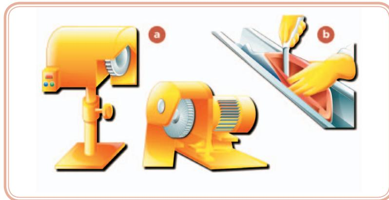
**Figura 1.6: Máquina para evisceração: (a) escovas rotatórias usadas na limpeza da cavidade corporal e remoção dos tecidos renais; (b) aspirador de sucção manual para remoção dos rins e limpeza da cavidade**
