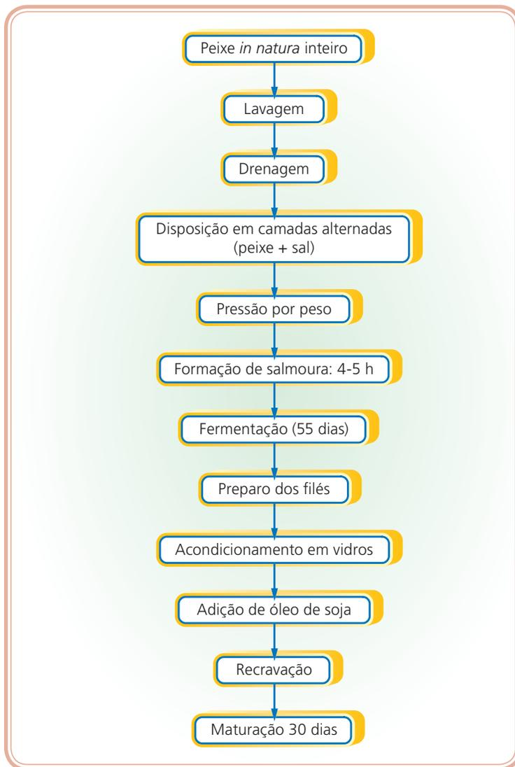
**Figura 8.1: Fluxograma de processamento do peixe fermentado**
