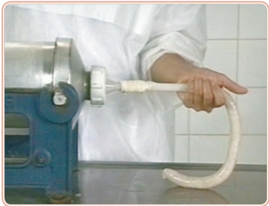
**Figura 7.7: Processo de embutimento**
